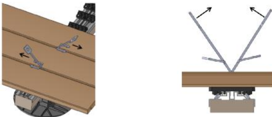
Figura 13: a sinistra : le chiavi vengono azionate facendo leva contemporaneamente. A destra , l'azione crea il distacco delle clips dalla sottostruttura senza compromettere l'integrità di queste (disegni Grad™)
